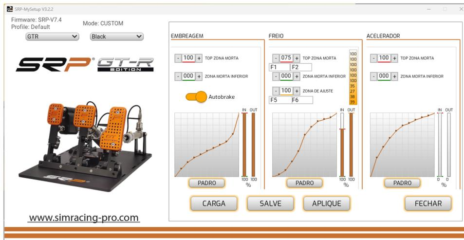
Temos de pressionar o travão no mínimo 25%, depois pressionamos a embraiagem mais de 98% durante 3 segundos e o travão ativa-se automaticamente a 100%,
